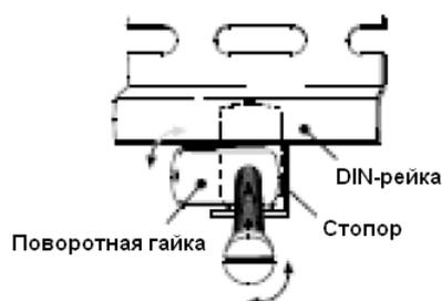
Рис. 16 – Крепление при помощи винта и поворотной гайки
